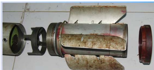
Gambar 10 Integrasi Rudder/fin dengan Motor Roket R-Han 122 B
