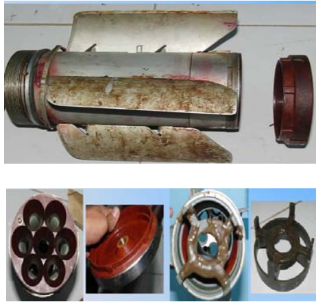
Gambar 8 . Integrasi Nozzle dengan Fin Roket 122 B
